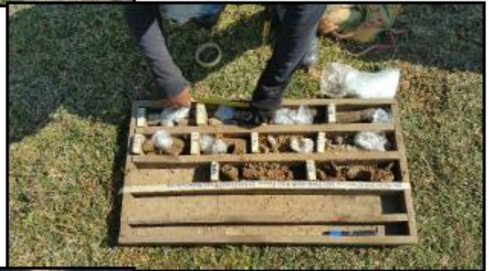
Foto 9. Caja de Testigos del sondeo SPT 2. Se diferencian 3 tipos de suelos.
