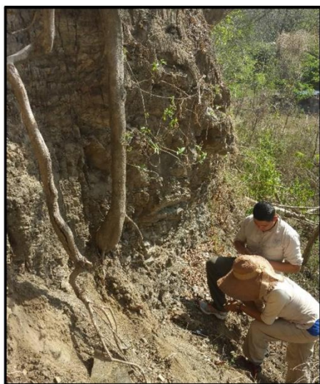
Foto 4. Inspección de afloramientos cerca del sitio, se observaron las rocas de la Formación Rivas: areniscas compactas, masivas en la parte superior y lutitas fisiles deleznales. En las coordenadas 649689 E, 1243578 N, a 3km al NW del sitio.
