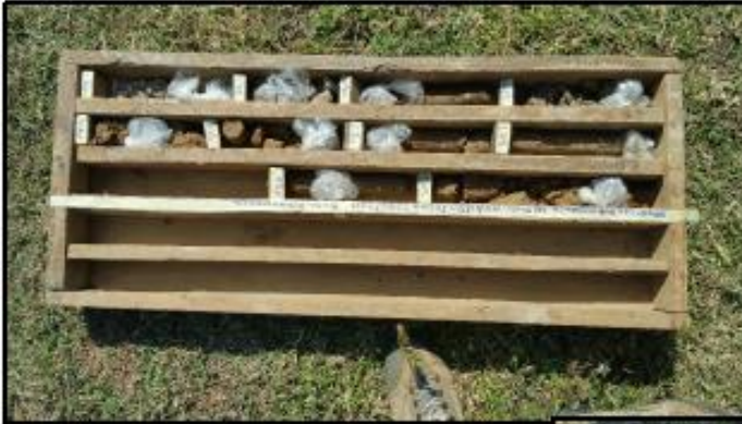
Foto 8. Caja de Testigos de Sondeo SPT 1.
